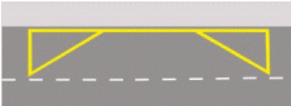
Marca Delimitadora de Estacionamento Regulamentado (BRANCA)
