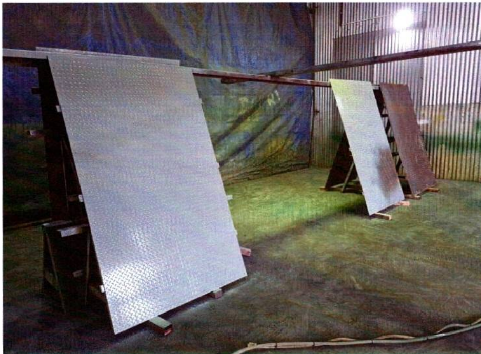
FOTO 05 – Detalhe dos pisos sendo pintados com acabamento alquídico de preparação de fundo realizado em fábrica.
