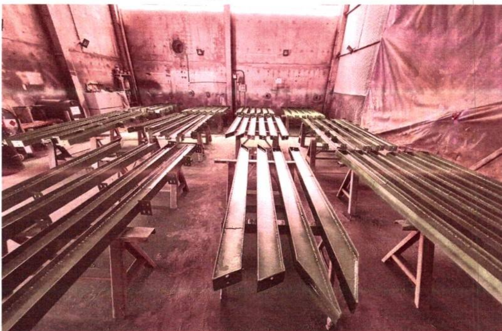
FOTO 03 – Detalhe da estrutura já revestida com acabamento em pintura epoxi verde folha realizada em fábrica.
