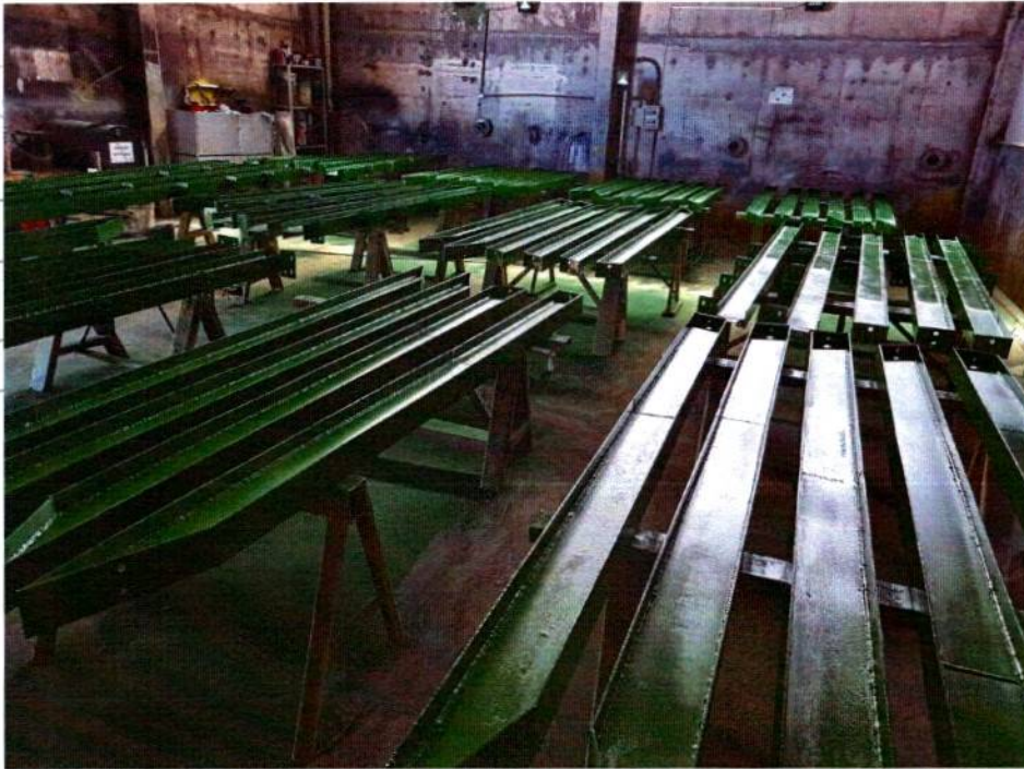
FOTO 04 – Detalhe da estrutura já revestida com acabamento em pintura epoxi verde folha realizada em fábrica.
