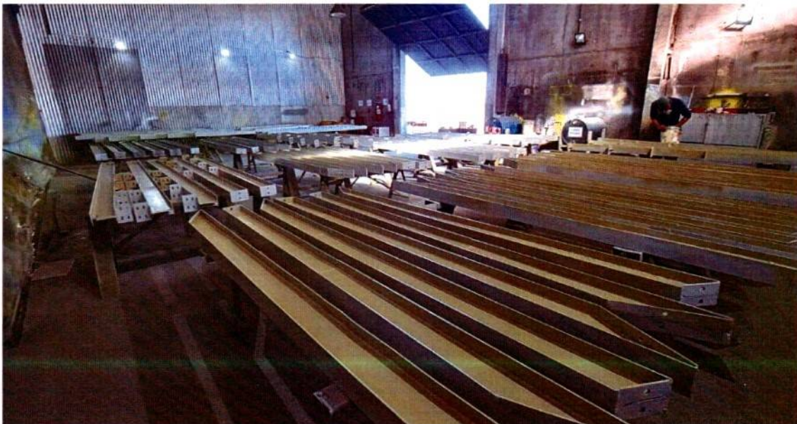
FOTO 01 – A frente, mão francesa com pintura de fundo e ao fundo vigas horizontais com mesma preparação.
