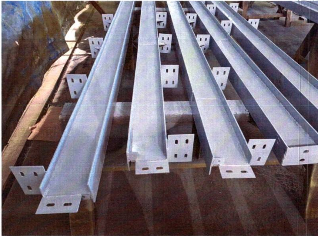
FOTO 02 – Detalhe próximo da pintura alquídica de fundo da estrutura horizontal.
