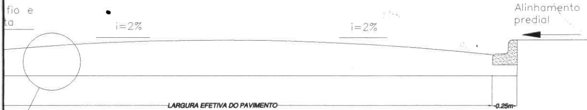
DETALHE - MEIO FIO COM SARJETA (cotas em cm)
